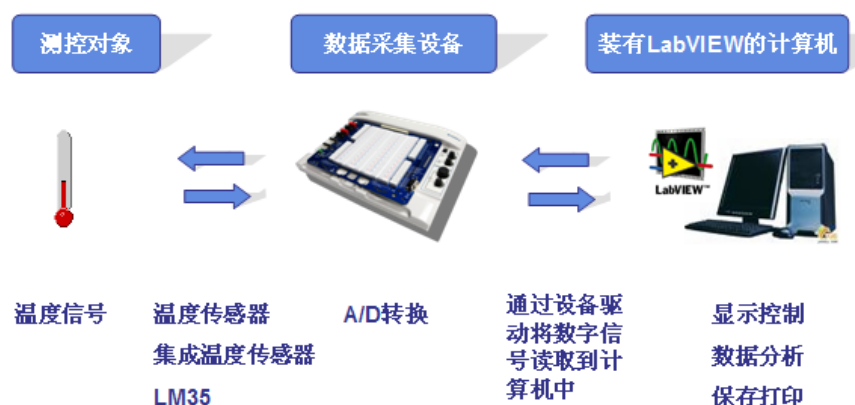
图 1 温度采集系统构架图
